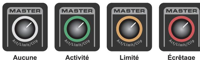
Pour des performances optimales, le niveau du système doit être réglé de manière à ce que l'indicateur Act/Limit/Clip soit principalement vert pendant l'utilisation. Une indication occasionnelle de limitation (jaune) est acceptable, mais l'appareil ne doit pas être utilisé au point d'écrêtage.
